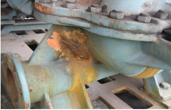
Hình 6. Thân bơm bùn LT8-250 bị thủng tại mỏ Mạo Khê
