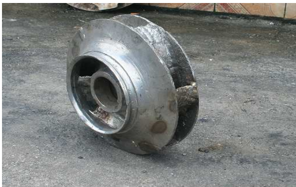
Hình 2. Cánh bơm 160m 3 /h tại mỏ Hà Tu (đã mòn hỏng và đang hàn đắp lại)
