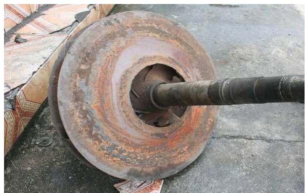
Hình 3. Cánh bơm 650m 3 /h tại mỏ Hà Tu bị mòn ở lõi vào của cánh dẫn
