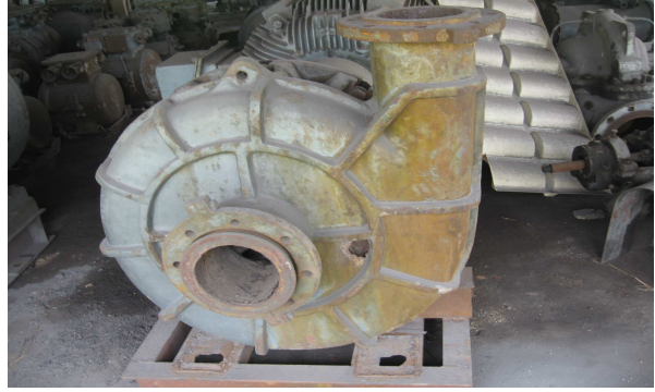
Hình 7. Thân bơm ly tâm bị thủng (đã hàn đắp) tại mỏ Mạo Khê
